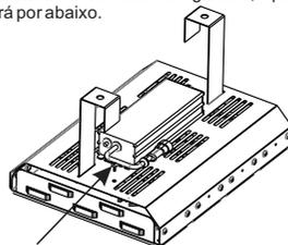
\* Para garantir a fixação da luminária recomenda-se o uso de parafusos entre o gancho e o perfilado.
