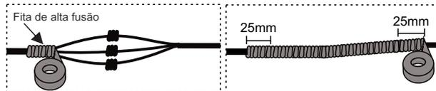
Recomenda-se que seja aplicada por fim, sobre a fita de alta fusão, uma camada extra de fita isolante comum, para evitar o ressecamento.
